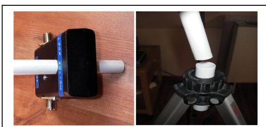
Mancher Loopbauer kämpfte schon mit den Koppelschleifen. Die Mathematik (Mainloop/5) ist wertvoll um eine Größenordnung zu erhalten, die Feinabstimmung erfolgt empirisch. Mit einer Koppelschleife ø 20 cm erreiche ich auf allen 7 Bändern ein SWR von 1/1 bis 1/1,5. Auch kleinere Durchmesser funktionieren gut. Wer wenig Feingefühl besitzt sollt sich einen Drehko mit Feinantrieb besorgen.
